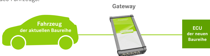
Bild: FD-L als Gateway zwischen Fahrzeug und ECU
